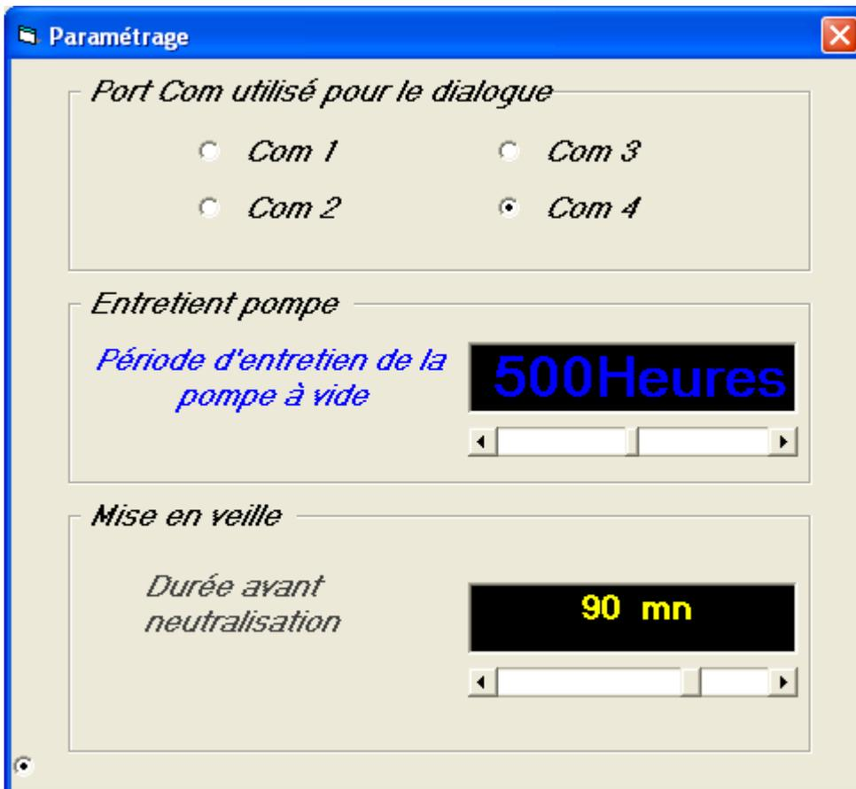
Indiquer sur quel port COM le câble à été installé. Le champ « Entretien pompe » permet de générer un appel à maintenance sur la pompe à vide après le temps de fonctionnement spécifié, ici 500 Heures. En effet le temps de marche de la pompe à vide est comptabilisé par le logiciel. Il est indiqué dans l'écran de synoptique que nous verrons plus
