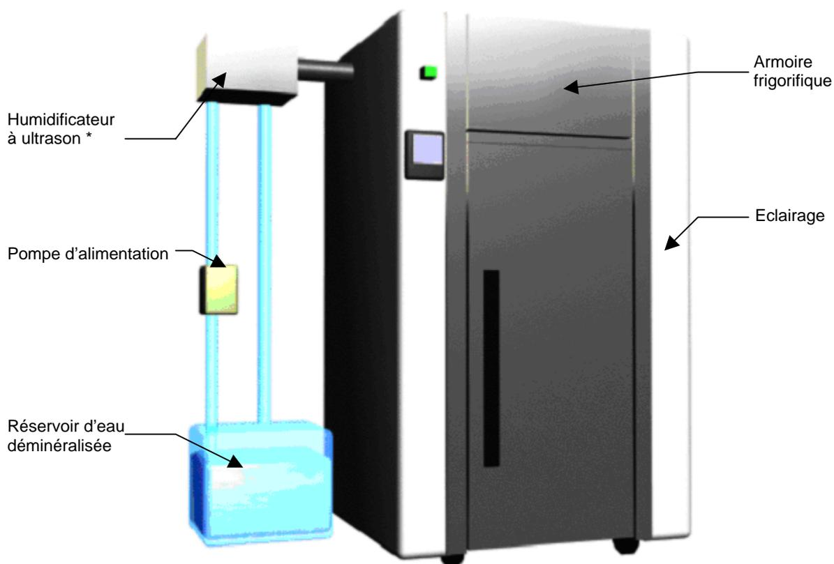
\* circuit d'humidification situé dans le carénage arrière.
